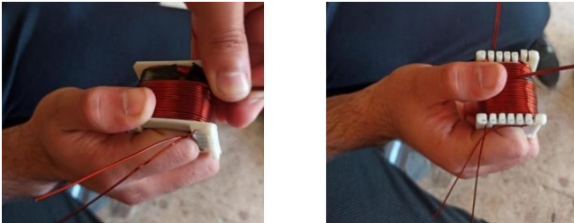
Şekil 4.1. Trafonun sarım aşamaları
