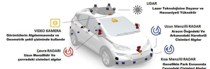
Şekil 3: Otonom araçlarda kullanılan bazı sensörler.[10]
