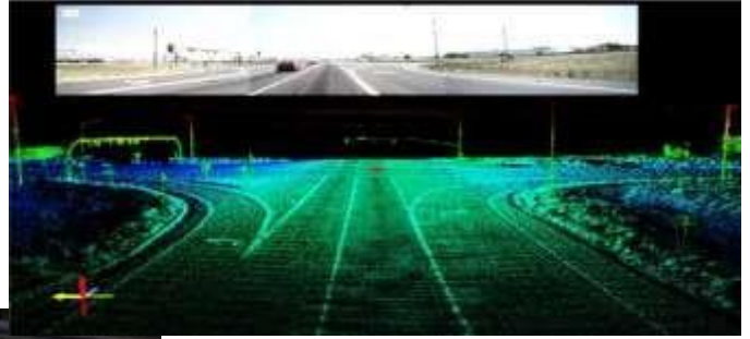
Şekil 4 : Toplanan LIDAR görüntüsü ve ilgili fotoğraf görüntüsü [19]
